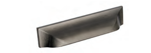
Maniglia 585 finitura acciaio ossidato semiopaco anta L 15 → passo 64 mm anta da L 30 a L 120 → passo 160 mm
